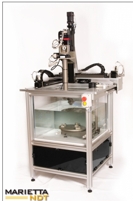
Figura 2.5 – Tanque de imersão de cinco eixos da fabricante Marietta NDT [MARIETTA NDT 2012].
