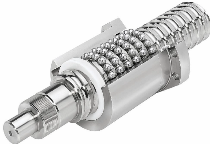
Figura 4.6 – Fuso de esferas recirculantes, com castanha em corte [Mec Parts 2012].
